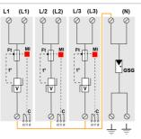
V: Hoch-Energie Varistor GSG: Gasgefüllte Funkenstrecke Ft: Thermische Sicherung C: Fernsignalisierung t\*: Thermische Trennvorrichtung MI: Fehlersignalisierung
