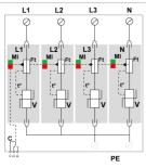
V: Hoch-Energie Varistor Ft: Thermische Sicherung C: Fernsignalisierung t°: Thermische Trennvorrichtung MI: Fehlersignalisierung
