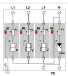
V: Hoch-Energie Varistor GSG: Gasgefüllte Funkenstrecke Ft: Thermische Sicherung C: Fernsignalisierung t\*: Thermische Trennvorrichtung MI: Fehlersignalisierung
