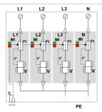
V: Hoch-Energie Varistor Ft: Thermische Sicherung C: Fernsignalisierung t\*: Thermische Trennvorrichtung MI: Fehlersignalisierung
