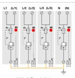
V: Hoch-Energie Varistor Ft: Thermische Sicherung C: Fernsignalisierung t°: Thermische Trennvorrichtung MI: Fehlersignalisierung
