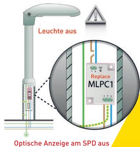
Für verdeckt verbaute SPD, wie z.B. im Leuchtenmast oder in Leuchten, macht es oft Sinn, den Stromkreis der Leuchte abzuschalten. So wird indirekt der Fehler des SPD nach außen signalisiert. Der Installateur kann dann durch Sichtprüfung am SPD vor Ort erkennen, ob das SPD ausgelöst hat.
