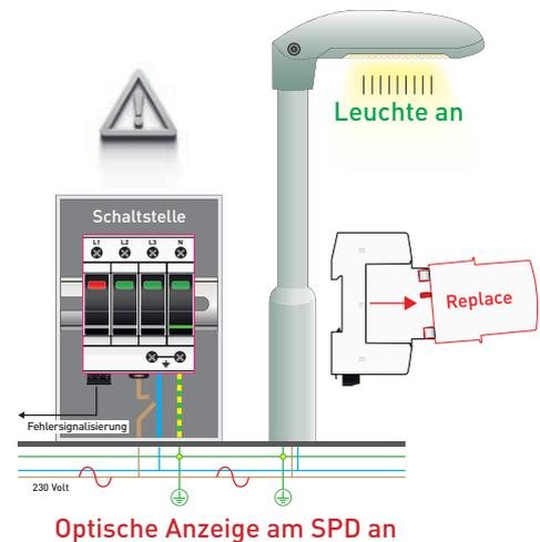
In einer zentralen Straßenbeleuchtungsschaltstelle macht es wenig Sinn, im Fehlerfall des SPD den Stromkreis der Anlage zu trennen. Die Straßen wären komplett im Dunkeln. Hierfür bieten sich SPD ohne Stromkreistrennung an. Diese trennen sich nur selber, zeigen den Fehler des fehlerhaften Poles an und melden den Fehler bei Bedarf über einen potentialfreien Kontakt an eine Zentrale. Der fehlerhafte Pol kann danach einfach ausgetauscht werden.
