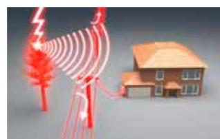
Einkopplung durch Strahlung
