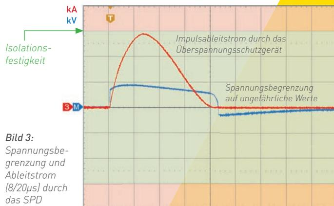
Bild 3: Spannungsbegrenzung und Ableitstrom (8/20µs) durch das SPD
