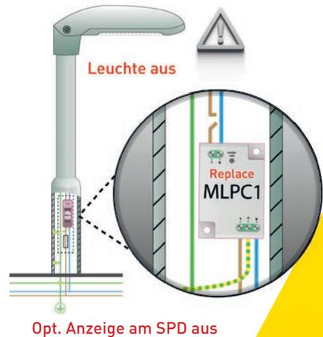
Für verdeckt verbaute SPD, wie z.B. im Leuchtenmast oder in Leuchten, ist es dagegen oft sinnvoll, den Stromkreis der Leuchte mit abzuschalten. So wird indirekt der Fehler des SPD nach außen signalisiert. Der Installateur kann dann durch Sichtprüfung am SPD vor Ort erkennen, ob das SPD ausgelöst hat und es bei Bedarf tauschen.
