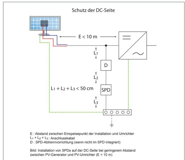
Werden Leitungslängen auf der AC- wie auch auf der DC- Seite >10m erreicht, werden 2 Überspannungsschutzgeräte benötigt.
