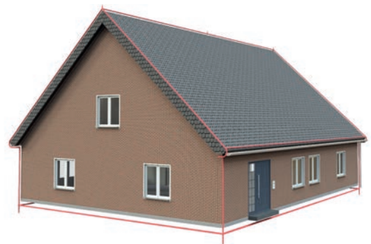
Haus mit äußerem Blitzschutz
