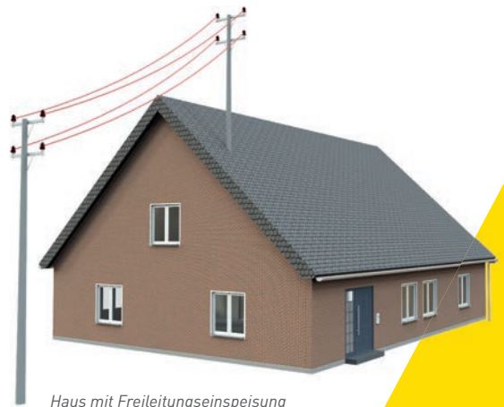
Haus mit Freileitungseinspeisung
