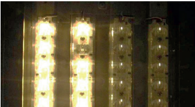
Teilweiser Ausfall von LED-Modulen
